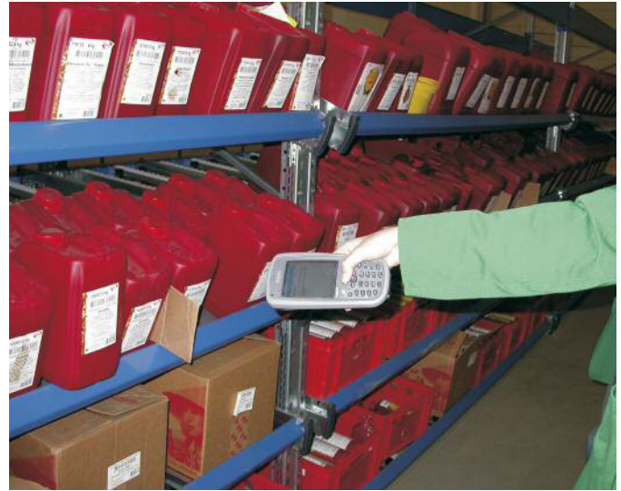
Mit der Imager-Technik müssen Barcodes nicht so exakt getroffen werden, wie es bei Laserscannern notwendig ist
